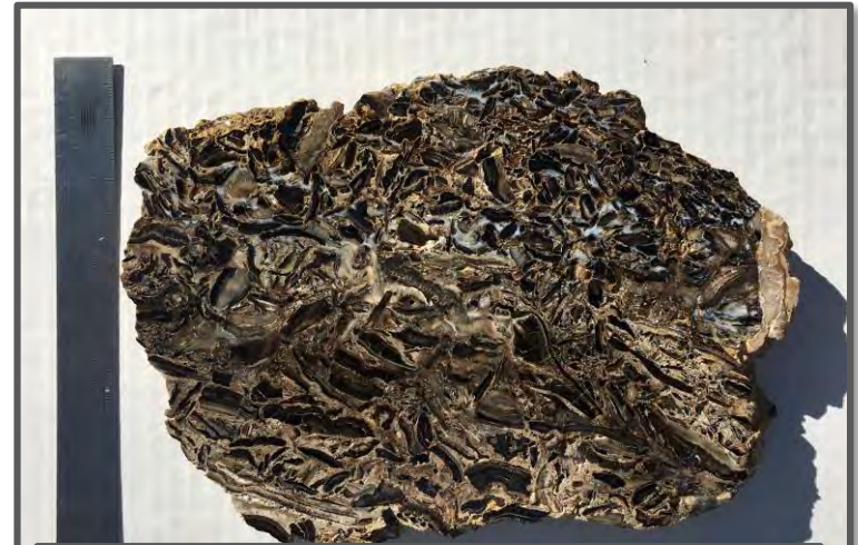
Implosion breccia, 480 gpt Au, 9,660 gpt Ag
